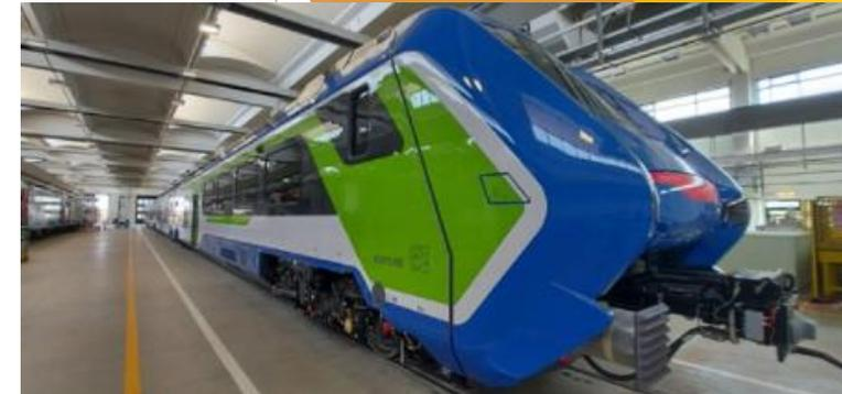
Funzionamento a batterie: per tratte di avvicinamento a stazioni, brevi soste e partenza dalle stazioni, con conseguente abbattimento di inquinamento acustico e risparmio carburante.
