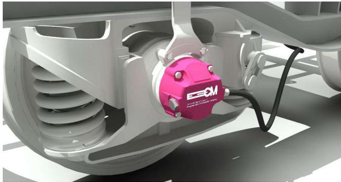
Esempio installazione dispositivi di diagnostica ruote treno (auto alimentato grazie harvesting energia, discernimento ruota piatta, deagliamento, surriscaldamento boccole e geo-localizzazione).
