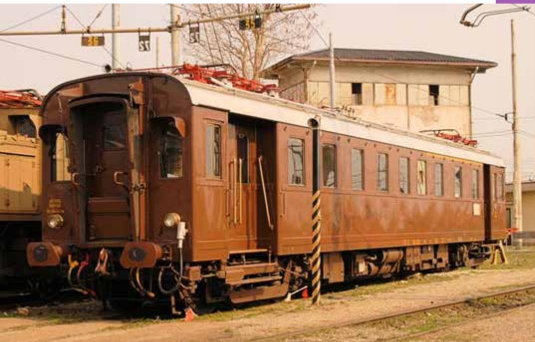
*Le elettromotrici gruppo E 623 "Varesine" furono ottenute dalla trasformazione a 3 kV e con presa a pantografo, avventa negli anni '50, dei precedenti gruppi E 10 ed E 60 del 1932 utilizzati sulla linea Milano - Varese - Porto Ceresio con terza rotaia alimentata a 600 V. Le "Varesine" furono una presenza costante a Milano Centrale nel dopoguerra ed oggi ritornano per Move.App Expo 2014.*
