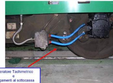
Generatore Tachimetrico e collegamenti al sottocassa
