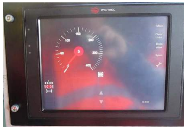
Livello 1 – Modo LS: velocità obiettivo 0 Km/h senza velocità di rilascio per occupazione cdb a valle del segnale di partenza (informazione restrittiva inviata da RIU) Intervento frenatura per superamento velocità
