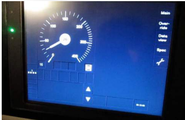
Livello 1 – Modo LS: velocità obiettivo 0 Km/h con Vrilascio = 15 Km/h Safe Radio Connection con RIU non attiva
