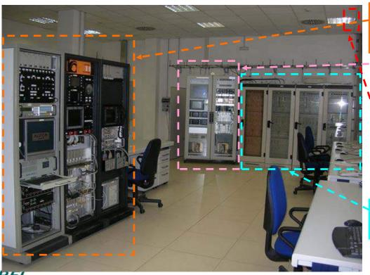
Ambiente di simulazione con Macchine target SSB Alstom (include modulo SCMT STM)
